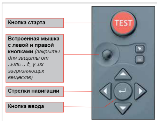
Крупный план панели управления анализатора FRAX 150
