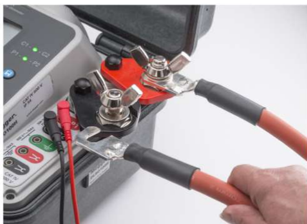
Новый адаптер для клемм позволяет применять диагностические выводы пользователя
