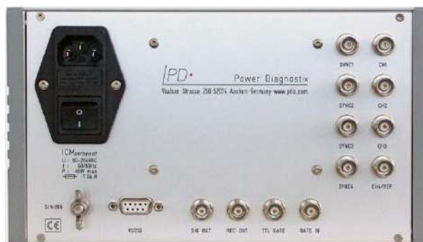
Обратная сторона анализатора «ICMcompact» с мультиплексором MUX4, интерфейсом RS232 и блоком функции измерения RIV
