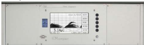
19" версия для установки в стойку
