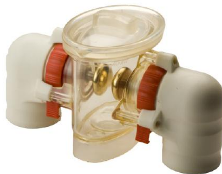
Ячейка объемом 400 мл в сборе (электроды вставлены)
